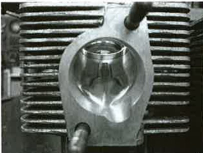
シリンダーヘッドもポート磨削など手間をかけている。ただし、カムシャフトはあえてノーマルを使用
