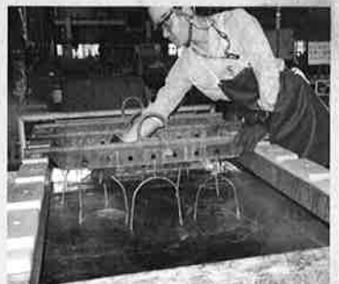
④ 少量の処理では、メッキ中のかかはんも手作業となる
