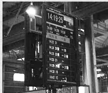
⑥ 無電解メッキの膜厚は、液に漬ける時間でコントロールする。このようなディスプレイで、時間の管理がなされている
