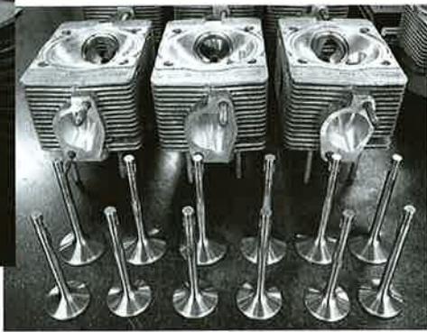
シリンダーヘッドもポート磨削など手間をかけている。ただし、カムシャフトはあえてノーマルを使用
