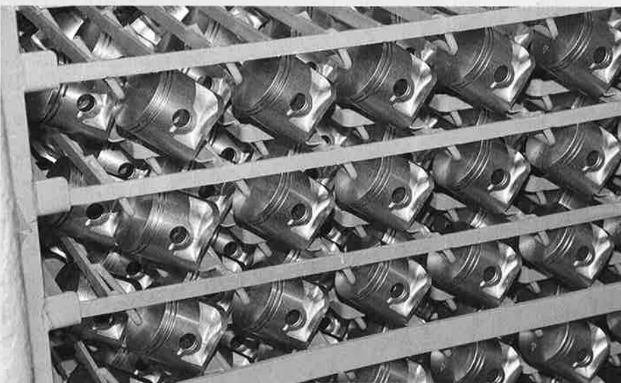
これは発電機用のピストン。別の大量生産向けラインで処理されている
