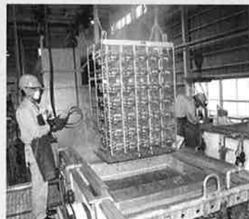
⑤ このラインでも、ある程度数がまとまれば、このように専用のハンガーが使われる
