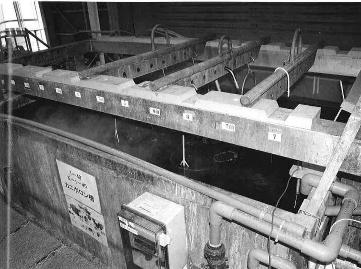
③ これがカニボロン用の液槽。液は温度、濃度とも自動管理されている。この液槽に漬けておくだけで、電気メッキより強固な皮膜ができるというのは非常に不思議だ。ちなみに、このラインは最先端というイメージとは程遠いように見えるが、少量多品種向けのラインであるため、大量生産用のラインも別途あり、そちらは高度に自動化されている
